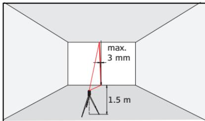
Como referência, utilizar um fio de prumo o mais próximo possível de uma parede com uma altura aproximada de 3 m.
