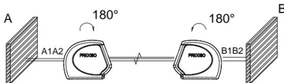
Accendere il laser a linee trasversali per il livellamento orizzontale in modalità non bloccata. Installare lo strumento su un treppiede a metà distanza fra due pareti (A+B).
