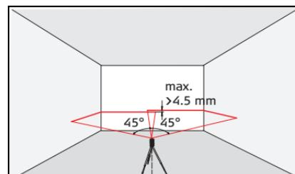
Installez l'instrument à 5 m du mur, allumez-le, déplacez-le de gauche à droite ou l'inverse, comparez les extrémités du faisceau laser du côté droit et du côté gauche pour repérer une différence de hauteur. Si la différence ne dépasse pas 4,5 mm, l'instrument se trouve dans la plage de tolérance.
