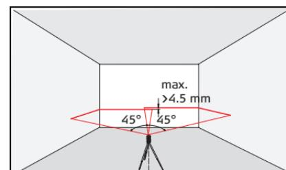
Разместите прибор на расстоянии 5 м от стены, включите его, передвиньте его слева направо или сравните левый и правый концы луча для определения перепада высот. Если разница не более 4,5 мм, значит точность прибора в пределах допустимого.
