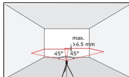
Colocar o instrumento a 5 m de uma parede; ligar o instrumento e deslocá-lo da esquerda para a direita (ou inversamente); comparar ambas extremidades (direita e esquerda) do feixe de laser para determinar a diferença de alturas. Se a diferença não for superior a 4.5 mm, o instrumento encontra-se dentro do intervalo de tolerância nominal.
