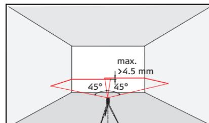
将仪器放置在离墙 5 米远的地方，打开仪器并将其从左至右或从右至左移动，然后比较右侧与左侧激光端的高度差。如果高度差未超过 4.5 毫米，则表示您的仪器在误差范围内。
