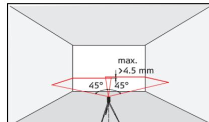
Posizionare lo strumento a una distanza di 5 metri dalla parete, accenderlo, spostarlo da destra a sinistra o viceversa, confrontare le estremità del raggio sul lato destro e sinistro al fine di determinare la differenza di elevazione. Se la differenza non supera i 4,5 millimetri, lo strumento è nei limiti della tolleranza.
