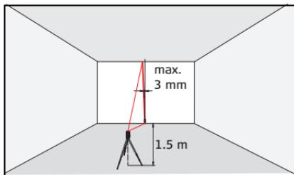
Как точку отсчета используйте отвес и установите его как можно ближе к стене высотой приблизительно 3 м.
