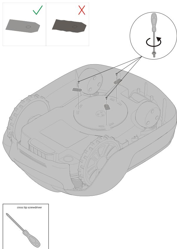
**UPOZORENJE!** Pritisnite gumb STOP i izvadite sigurnosni ključ prije zamjene noževa i nosite zaštitne rukavice.
