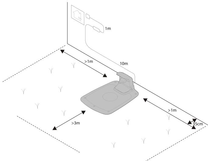
Stację ładowania należy ustawić w następujący sposób:
