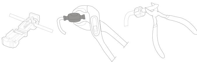
Când firul delimitator este întins complet și fixat, instalați conectorii pentru capetele firului după cum urmează:
