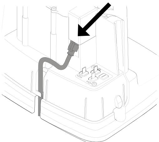
Connectez le câble basse tension à la station de charge.
