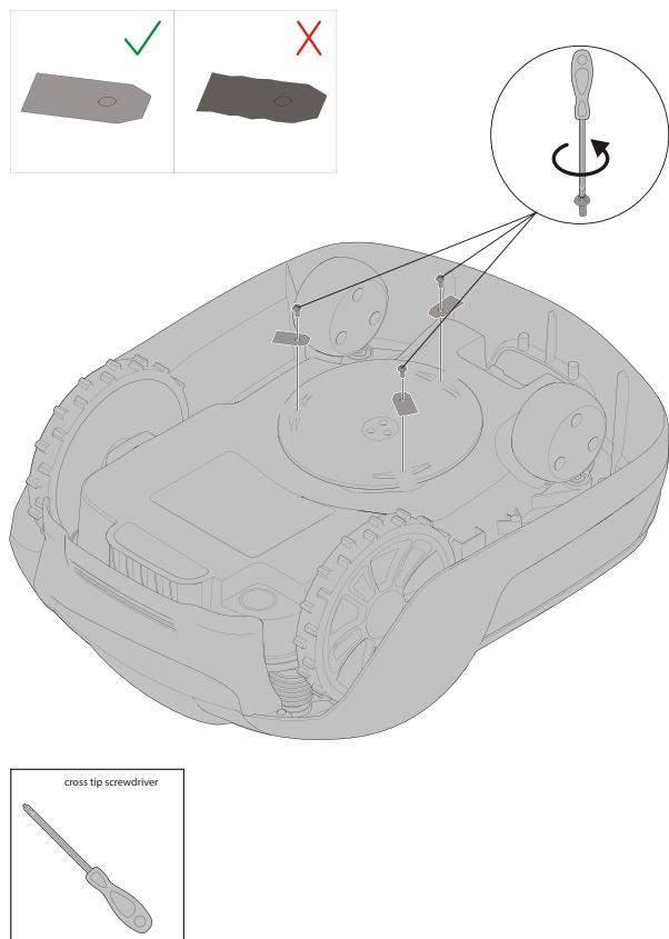
**AVVERTENZA!** Premere il tasto di ARRESTO e rimuovere la chiave di sicurezza prima di sostituire le lame; indossare guanti protettivi.
