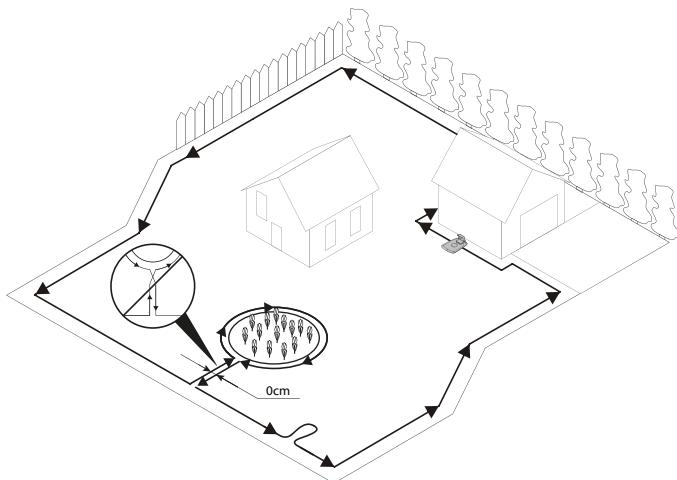
Fissare temporaneamente l'estremità della bobina di cavo a un piolo o a un altro oggetto in corrispondenza della stazione di ricarica.
