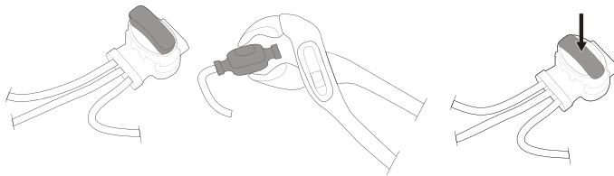
Oba konca mejne žice in konec vodilne žice vstavite v spojko in konektor vodilne žice. Prepričajte se, da so žice povsem vstavljenе v spojko in konektor vodilne žice, tako da sta konca vidna skozi spojko in konektor vodilne žice.
