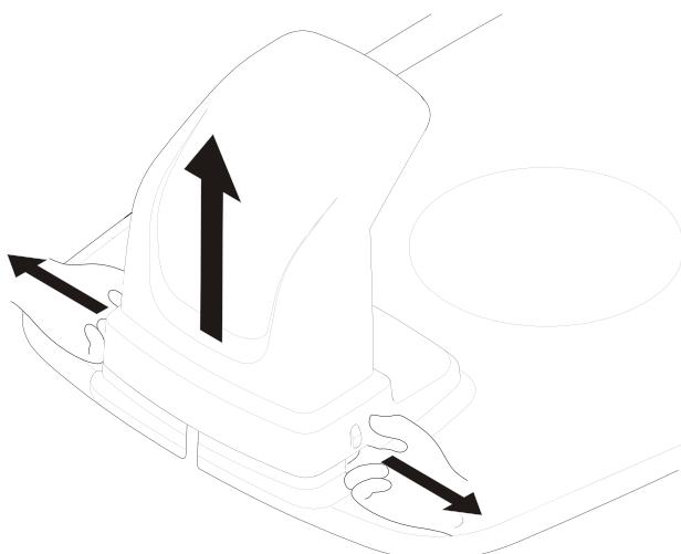
Odstaňte ochranný kryt na nabíjecí stanici stlačením úchytka na každé straně základny a odklopením víka.
