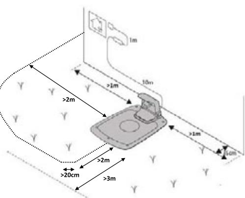
Før styrekablet hen til sløjfen på afgrænsningskablet, hvor styrekablet skal tilsluttes.
