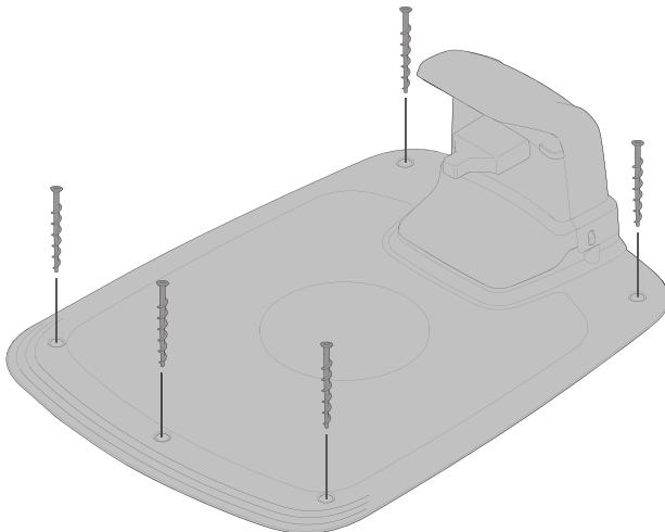
Ukotvite nabíjaciu stanicu na zem pomocou piatich dodaných upevňovacích skrutiek a 6 mm šesthranného kľúča.
