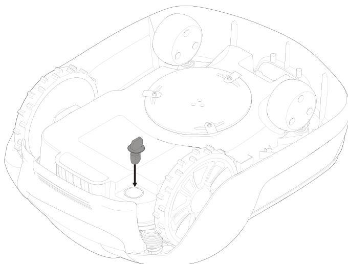
Vstavite varnostni ključ v spodnjo stran kosilnice in ga obrnite v položaj **Enable** (Omogoči).
