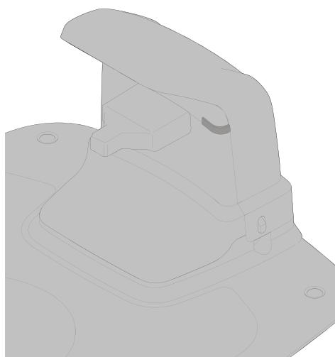
Fissare la stazione di ricarica al terreno con cinque viti utilizzando una chiave esagonale da 6 mm.
