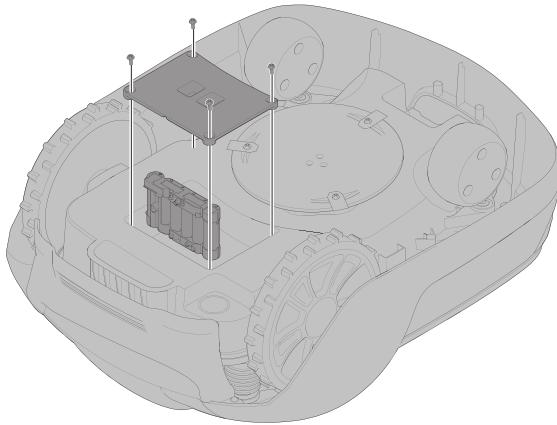
**OPOZORILO!** Pritisnite gumb STOP (USTAVI) in odstranite varnostni ključ, preden zamenjate baterije. Pri tem nosite zaščitne rokavice.
