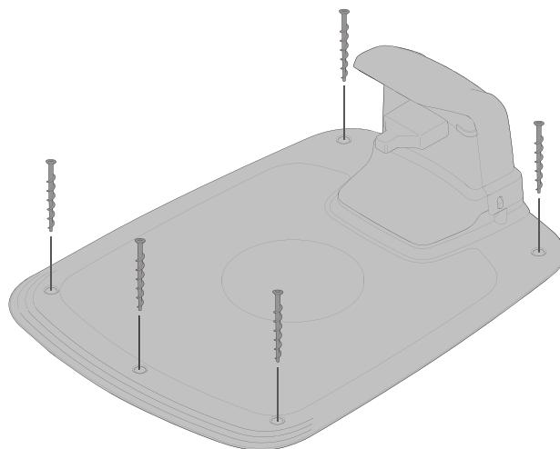
Шестигранным ключом на 6 мм закрепите зарядную станцию на земле пятью комплектными крепежными винтами.
