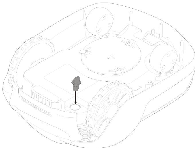
Stecken Sie den Sicherheitsschlüssel in die Unterseite des Mähers und drehen Sie ihn in die **aktivierte** Position.
