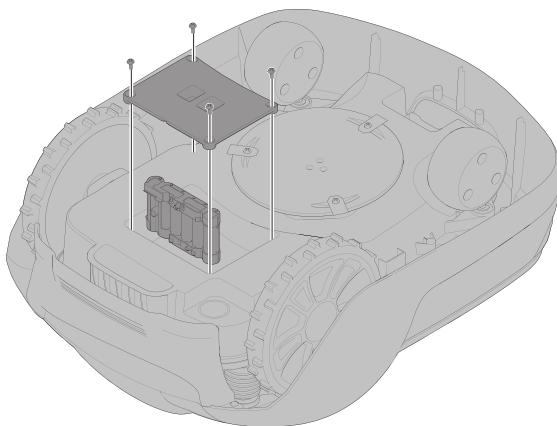
**AVERTISMENT!** Apăsați butonul STOP și îndepărtați cheia de siguranță înainte de a înlocui bateriile și purtați mănuși de protecție.
