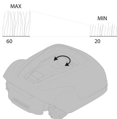
Sett klippehøyden til 60 mm de første ukene med gressklipping for å unngå å kutte grense- og ledekabelen. Senk innstillingen ett trinn hver uke etter dette til du har nådd ønsket klippehøyde.
