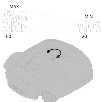
Para as primeiras semanas de corte, defina a altura de corte para 60 mm para evitar cortar o fio de delimitação e fio-guia. Reduza a configuração um passo a cada semana daí em diante até atingir a altura de corte desejada.
