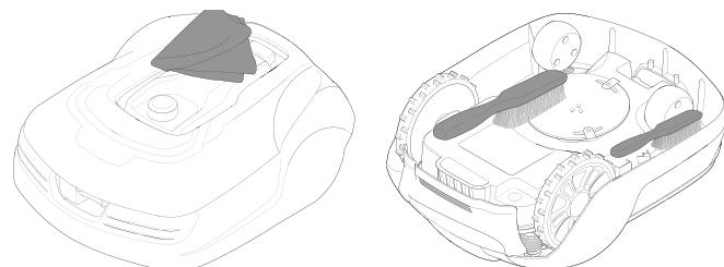
**VAROVANIE!** Stlačte tlačidlo STOP a pred čistením odstráňte bezpečnostný kľúč.
