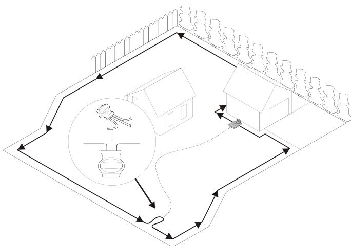
Klipparen använder sig av guidekabeln som tillval för att hitta tillbaka till laddstationen, men även för att hitta svåråtkomliga delar inom användningsområdet. Guidekabeln dras exempelvis mellan laddstationen och en avlägsen del av användningsområdet eller genom en smal passage.
