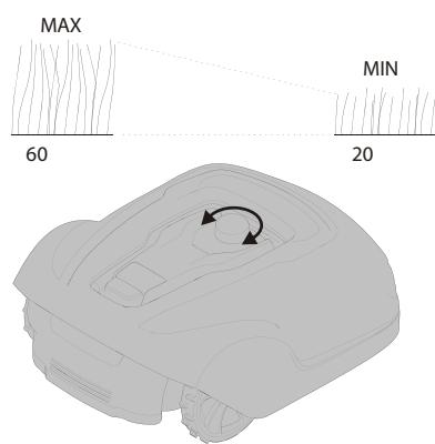
În primele săptămâni de tuns, setați înăltimea de tăiere la 60mm pentru a evita tăierea firului de delimitare și a firului de ghidare. Coborâți înăltimea cu un nivel în fiecare săptămână după aceasta până când înăltimea de tăiere dorită este obținută.
