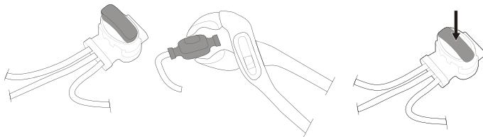
Insira ambas as extremidades do fio de delimitação, bem como o fim do fio-guia na união e o conector do fio-guia. Verifique se os fios estão totalmente inseridos no espaçador e oriente o conector do fio-guia de modo às extremidades ficarem visíveis através da ligação e do conector do fio-guia.
