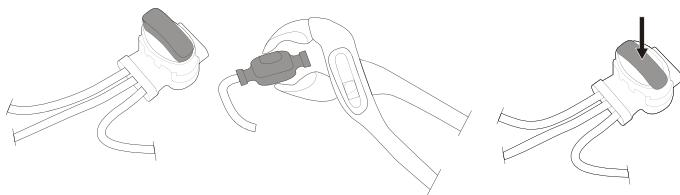
Vložte oba konce hraničného a vodiaceho kábla do spojky a konektora vodiaceho kábla. Skontrolujte, či sú drôty úplne zasunuté do spojky a konektora vodiaceho kábla, aby boli konce viditeľné cez spojku a konektor vodiaceho kábla.
