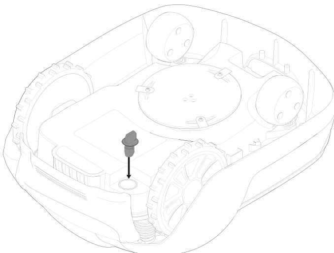
Vložte bezpečnostný kľúč do spodnej časti kosačky a otočte do polohy **Enable** (Povoliť).
