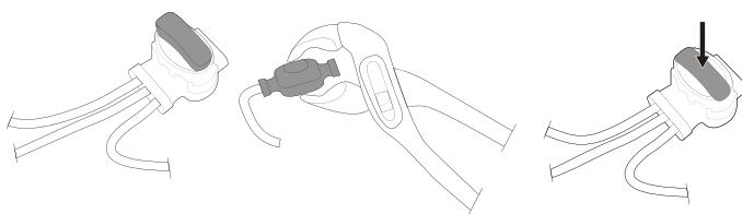
Stecken Sie beide Enden des Begrenzungsdrahts sowie das Ende des Führungsdrähtes in den Spleiß- und Führungsdrähtverbinder. Überprüfen Sie, ob die Drähte vollständig in den Spleiß- und Führungsdrähtverbinder eingeführt sind, so dass die Enden durch den Spleiß- und Führungsdrähtverbinder sichtbar sind.
