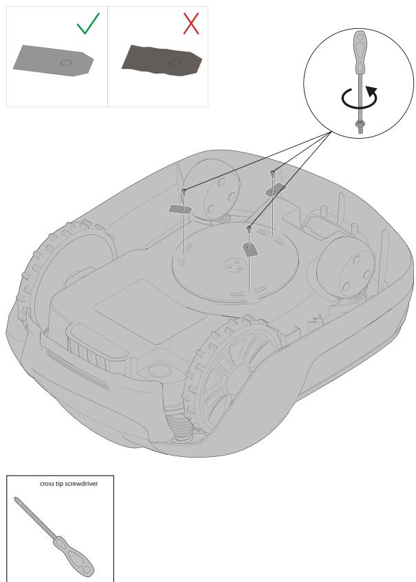
**FIGYELMEZTETÉS!** Nyomja meg a START gombot és távolítsa el a biztonsági kulcsot, mielőtt a késeket eltávolítaná, és viseljen védőkesztyűt. **FIGYELMEZTETÉS!** Csak a GLOBE késeket használjon: 333092355
