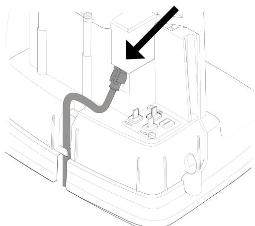
Sluit de laagspanningskabel aan op het laadstation.
