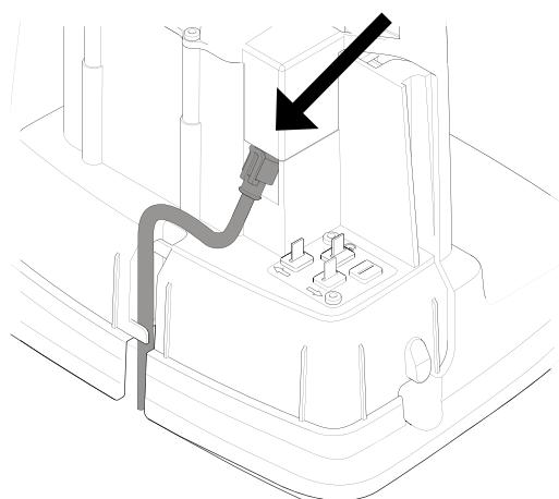
Zapojte nízkonapěťový kabel do nabíjecí stanice.
