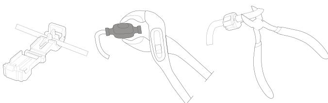
Gdy przewód graniczny będzie całkowicie poprowadzony i zamocowany, należy zainstalować końcowe łączówki przewodu pętli. Należy to zrobić w następujący sposób:
