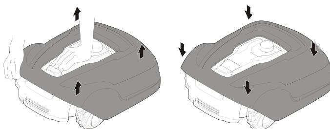
Apăsați robotul cu o mână și ridicați cu fermitate unul dintre colțurile caroserie și repetați procedura pentru toate colțurile, până când corpul este detașat de șasiu.
