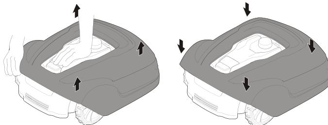
Segure o corta-relva com uma mão e levante firmemente em um dos cantos do corpo e repita para todos os quatro cantos, até que o corpo se solte do chassi.
