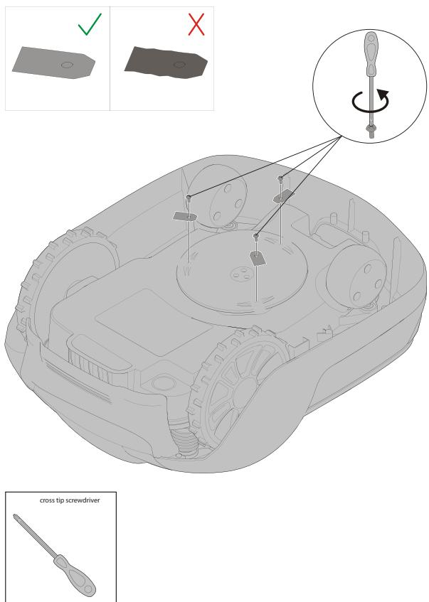
**WARNUNG!** Drücken Sie die STOP-Taste und ziehen Sie den Sicherheitsschlüssel ab, bevor Sie die Messer austauschen. Tragen Sie dabei Schutzhandschuhe.
