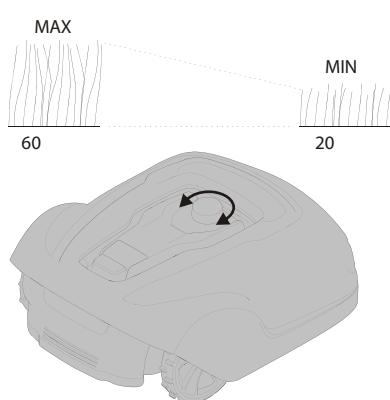
Aby nie dopuścić do przecięcia przewodu granicznego i przewodu prowadzącego, przez pierwszych kilka tygodni koszenia wysokość koszenia należy nastawić na 60 mm. Następnie ustawienie należy obniżać o jedną pozycję tygodniowo, aż do uzyskania żądanej wysokości koszenia.
