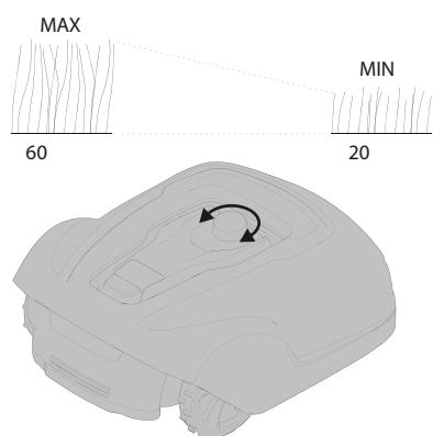
Ställ för de första veckornas klippling in klipphöjden på 60 mm för att se till att begränsningskabeln och guidekabeln inte klipps. Sänk därefter inställningen ett steg varje vecka tills den önskade klipphöjden nås.
