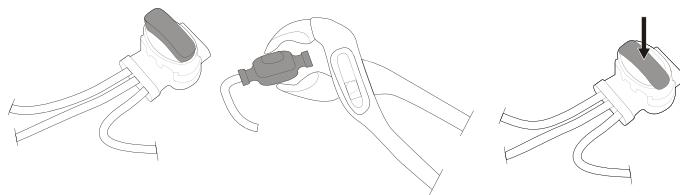
Írasson a huzaloldalú vezetőhuzal minden két végét és a vezetőhuzal végét a huzaltoldó vezetőhuzal összekötőbe. Ellenőrizze, hogy a huzalok teljesen a huzaltoldó vezetőhuzal összekötőben vannak-e úgy, hogy a végek láthatóak a huzaltoldó összekötőn keresztül.
