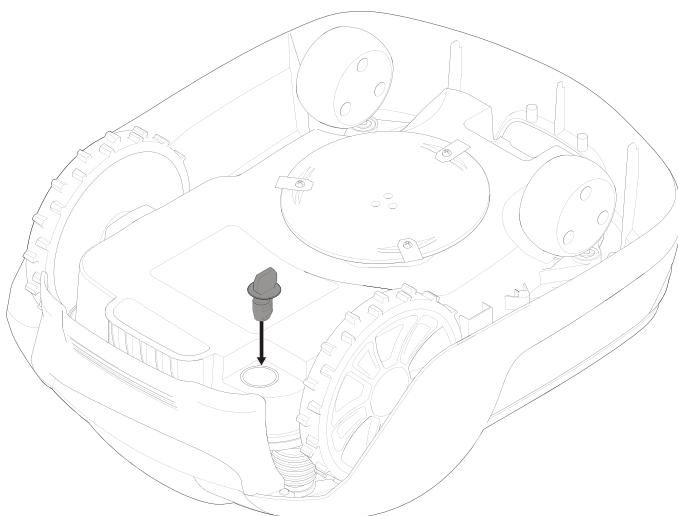
Włożyć kluczyk zabezpieczający do stacyjki w podwoziu kosiarki i przekręcić go w pozycję **Włączone**.
