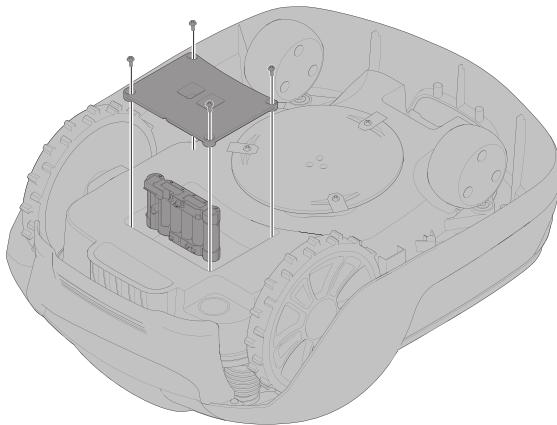
**AVISO!** Pressione o botão STOP e remova a chave de segurança antes de substituir a bateria e use luvas de proteção.
