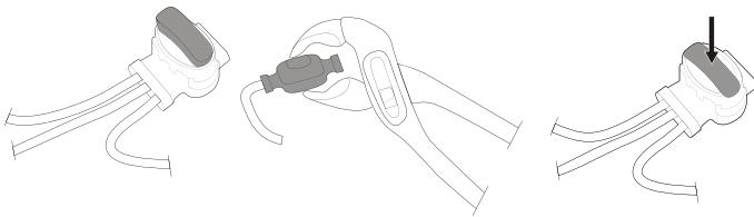
Fare arrivare il cavo guida fino all'occhiello del cavo perimetrale, nel punto cui verrà collegato il cavo guida.
