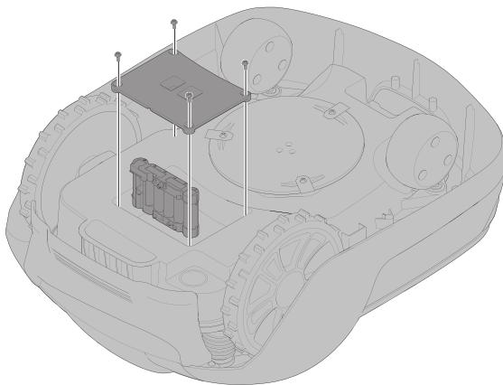
**¡ADVERTENCIA!** Pulse el botón de PARADA y retire la llave de seguridad antes de sustituir las baterías y lleve guantes de protección.
