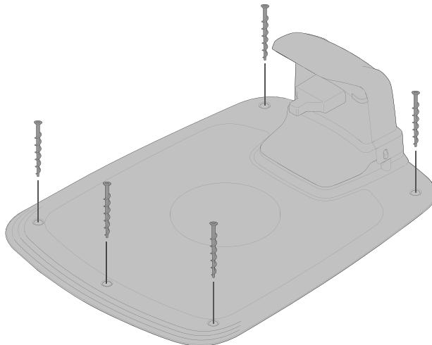
Säkra laddstationen mot marken med de fem medföljande fästskruvarna med hjälp av insexnyckeln på 6 mm.
