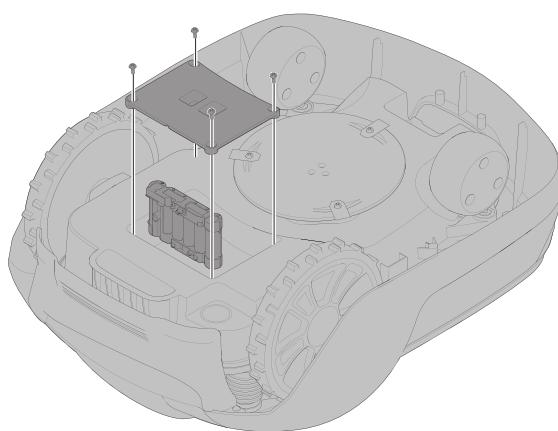
**VAROVANIE! Stlačte tlačidlo STOP a pred výmenou batérie vyberte bezpečnostný kľúč a nasaďte si ochranné rukavice.**
