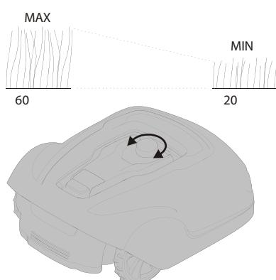
В течение нескольких первых недель эксплуатации высота скашивания травы должна составлять 60 мм, чтобы исключить контакта ножей с пограничным и направляющим проводами. Уменьшайте высоту скашивания травы каждую неделю, пока не будет достигнута желаемая высота скашивания.
