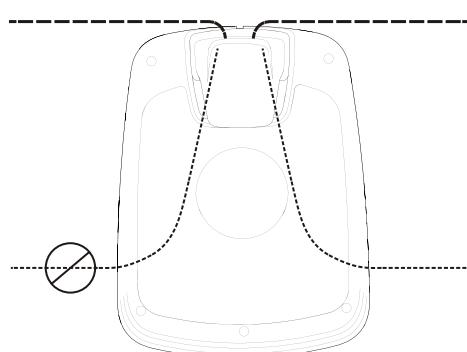
A estação de carregamento deve estar completamente dentro da área de funcionamento, conforme apresentado na imagem.
