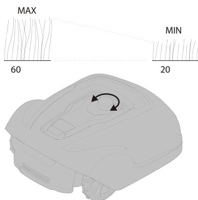
Durante las primeras semanas de corte, ajuste la altura de corte a 60 mm para evitar cortar el cable delimitador y el cable de guía. Posteriormente, baje el ajuste un paso cada semana hasta que se alcance la altura de corte deseada.
