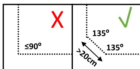
Il tosaerba utilizza il cavo guida facoltativo per individuare il percorso di ritorno verso la stazione di ricarica, ma anche per individuare le aree più difficili da raggiungere. Ad esempio, il cavo guida viene steso tra la stazione di ricarica e un punto lontano dell'area di lavoro oppure in un passaggio stretto.
