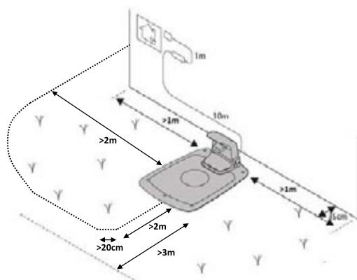
Przewód prowadzący należy poprowadzić do pętli na przewodzie granicznym, w punkcie, w którym ma być podłączony przewód prowadzący.
