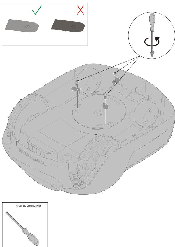
**VAROVANIE!** Stlačte tlačidlo STOP a pred výmenou čepelí vyberte bezpečnostný kľúč a nasaďte si ochranné rukavice.
