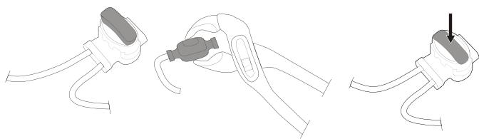
Hvis afgrænsningskablet er for kort, bruges medfølgende samler og stik til styrekablet for at splejse yderligere afgrænsningskabel på følgende måde:
