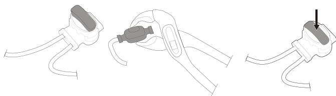
Je-li ohraničující drát příliš krátký, použijte k pripojení dalšího ohraničujícího drátu dodané spoje a spojky vodicího drátu, a to následujícím způsobem:
