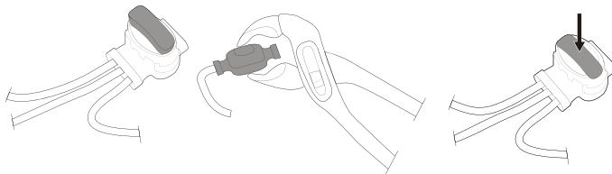
Поместите оба конца пограничного провода и направляющий провод в соединитель для сращивания внахлестку. Убедитесь, что оба провода установлены в соединитель так, чтобы их концы выдавались наружу соединителя.
