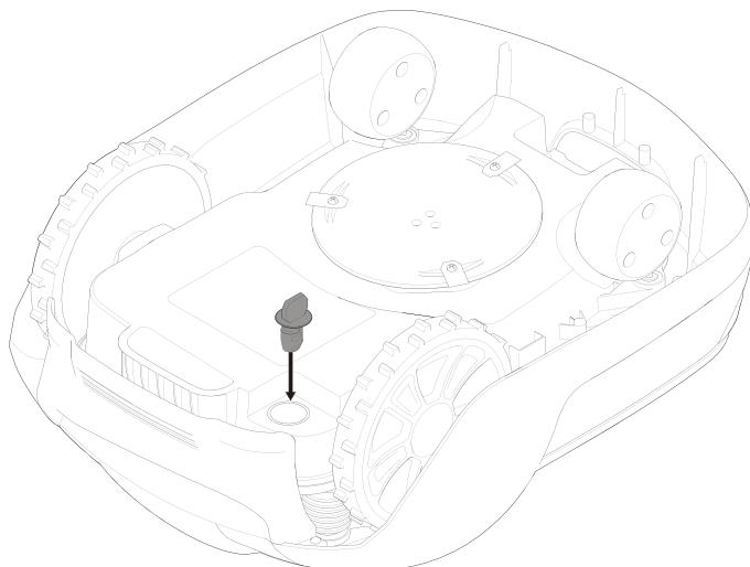
Inserire la chiave di sicurezza nella parte inferiore del tosaerba e ruotare fino a raggiungere la posizione **di attivazione**.
