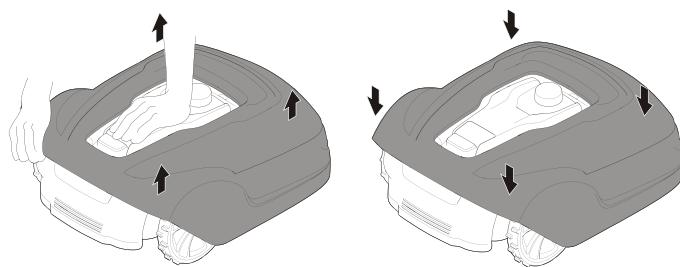
Sujete el cortacésped con una mano y levántelo firmemente por una de las esquinas de la carrocería y repita para las cuatro esquinas, hasta que la carrocería se suelte de la carcasa.
