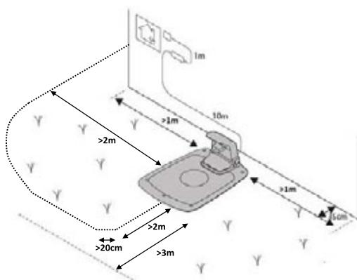
Führen Sie den Führungsdrat zur Schleife am Begrenzungsdrat, an der der Führungsdrat angeschlossen werden soll.
