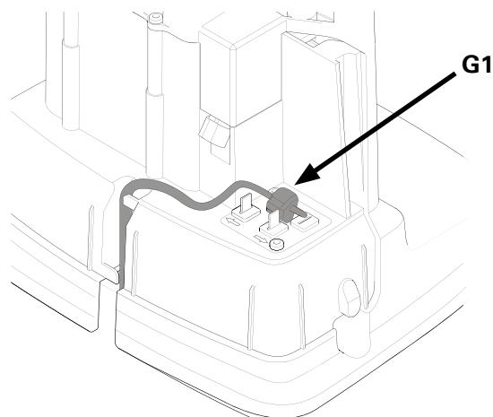
Inserte ambos extremos del cable delimitador así como el extremo del cable de guía en el conector de empalme y de cable de guía.
