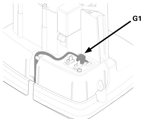
Schließen Sie den Führungsdräht wie folgt an die Ladestation an:
