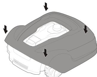
Hold gressklipperen nede med én hånd, og løft et av hjørnene på hoveddelen med en viss kraft. Gjenta dette for alle fire hjørner til hoveddelen spreter ut og løsner fra understellet.
