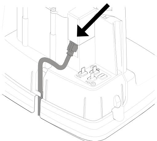
Podłączyć kabel niskonapięciowy do stacji ładowania.
