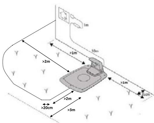
Прекарайте направляващия проводник до контура на ограничаващия проводник до мястото на свързване на направляващия проводник.
