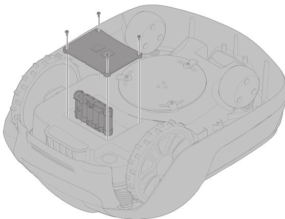
**ADVARSEL!** Tryk på stopknappen, og tag sikkerhedsnøglen ud før udskiftning af batterier. Husk beskyttelseshandsker.
