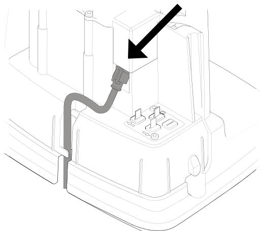
Csatlakoztassa a kisfeszültségű kábelt a töltőállomáshoz.
