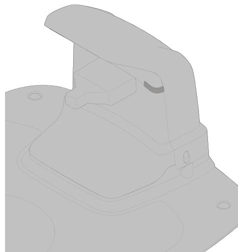
Proteja a estação de carregamento no chão usando os cinco parafusos de fixação fornecidos e uma chave Allen de 6 mm.
