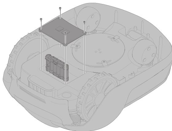
**AVVERTENZA!** Premere il tasto di ARRESTO e rimuovere la chiave di sicurezza prima di sostituire la batteria; indossare guanti protettivi.
