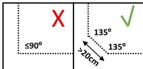
El cortacésped utiliza el cable de guía opcional para encontrar el camino de regreso a la estación de carga, pero también para encontrar zonas de difícil acceso en la superficie de trabajo. Por ejemplo, el cable de guía se coloca entre la estación de carga y una parte remota de la superficie de trabajo o a través de un pasillo estrecho.
