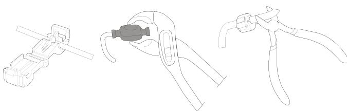
Keď je hraničný kábel úplne rozložený a zaistený, nainštalujte koncové konektory slučkového kábla nasledovne:
