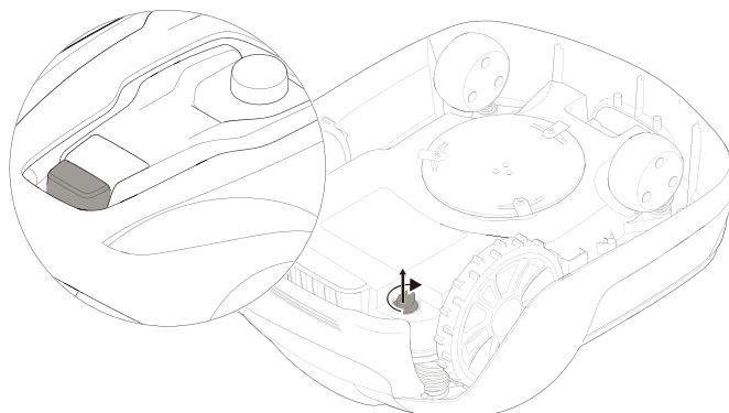
Apăsați butonul **STOP** de pe robot și îndepărtați cheia de siguranță.
