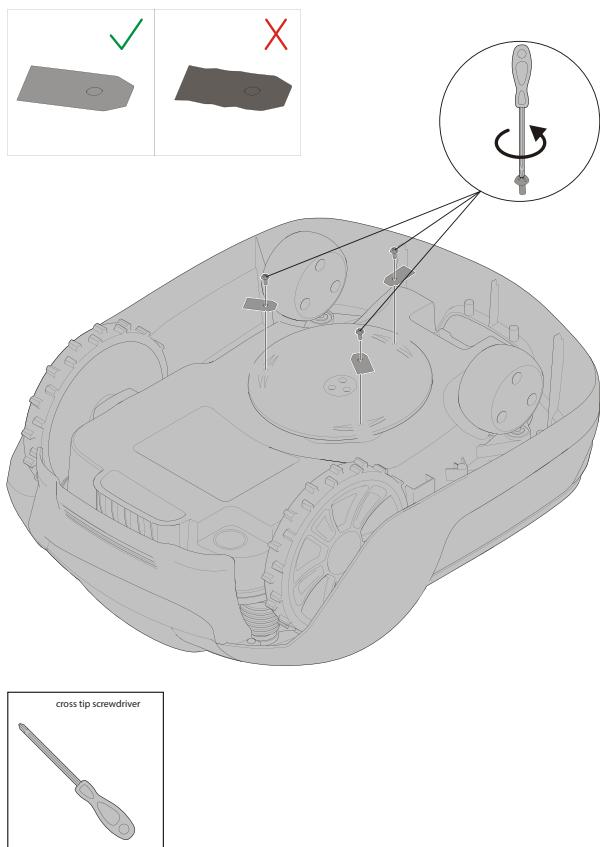
**OPOZORILO!** Preden zamenjate rezila, pritisnite gumb STOP (USTAVI) in odstranite varnostni ključ, pri tem pa nosite zaščitne rokavice.
