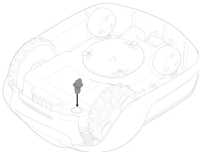
Insérez la clé de sécurité sous la tondeuse et tournez sur la position **Activé**.
