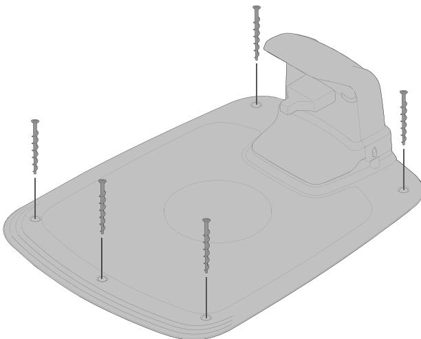
Gebruik een 6 mm inbussleutel om het laadstation aan de grond vast te maken met behulp van de vijf meegeleverde vastzetschroeven
