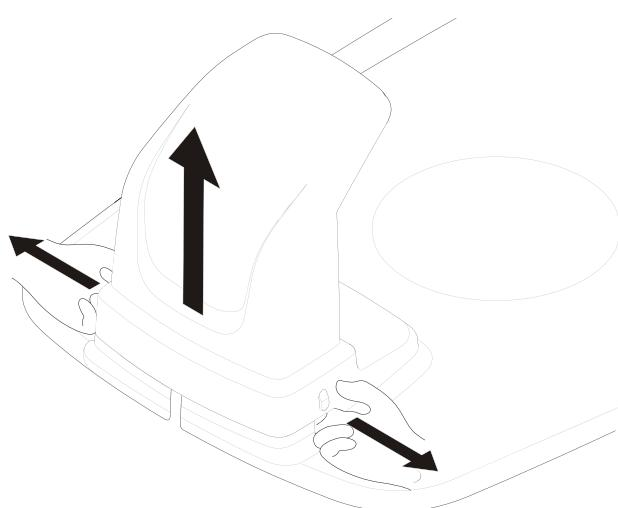
Retirez le cache de protection sur la station de charge en appuyant sur les languettes de chaque côté de la base tout en levant le cache.
