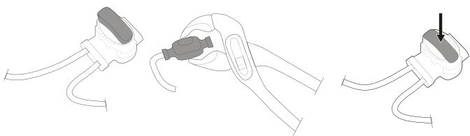
Если пограничный провод слишком короткий, используйте соединители для его удлинения следующим образом:
