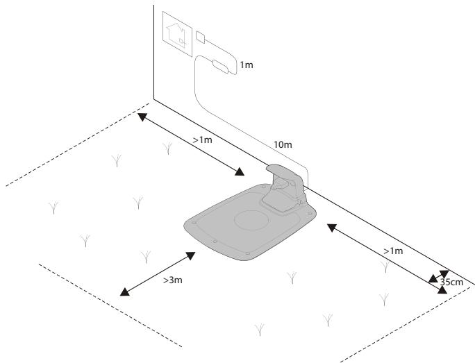
Pozitionarea stației de încărcare după cum urmează:
