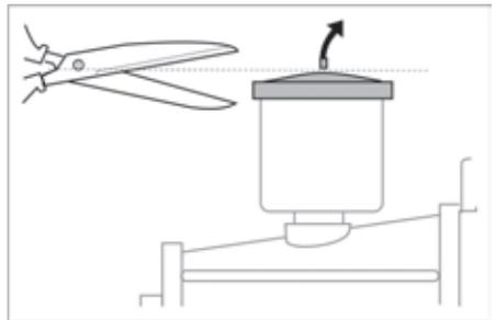
→ Kapa bort spetsen på locket till oljebehållaren på vattenpumpen före första användning.
