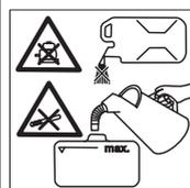
*Nu alimentați cu combustibil atunci când motorul funcționează.*
