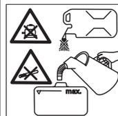
*Non fare rifornimento con il motore in funzione. Non fumare durante le operazioni di rifornimento. Non fare rifornimento direttamente dalla tanica, utilizzare un imbuto o un recipiente idoneo.*
