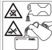
Não abastecer com o motor em funcionamento. Não fumar durante o abastecimento do combustível. Não abastecer directamente do bidon, utilizar um funil ou recipiente adequado.
