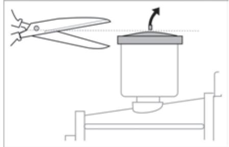
→ Kapa bort spetsen på locket till oljehållaren på vattenpumpen före första användning.
