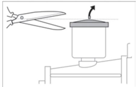
→ Перед первым использованием срезать кончик на колпачке емкости с маслом водяного насоса.
