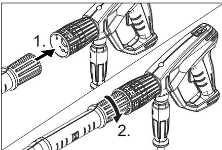
→ На струйную трубку установить сопло высокого давления.
