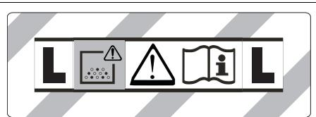
**ADVARSEL:** Maskinen inneholder helse-skadelig støv. Tømming og vedlikehold, inkludert fjerning av støvpose, skal kun utføres av sakkyndig personale som bruker egen personlig verneutstyr. Ikke slå på før hele filtersystemet er installert.
