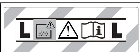
**ADVERTÊNCIA:** este aparelho contém pós nocivos para a saúde. O esvaziamento e manutenção, incluindo a eliminação do saco do pó, só podem ser realizados por pessoas qualificadas que utilizem equipamento de protecção pessoal adequado. Não ligar enquanto o completo sistema de filtração não estiver instalado.
