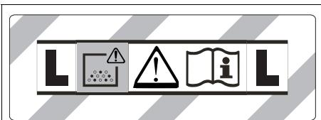
**UPOZORENJE:** Ovaj uređaj sadrži prašinu koja je štetna po zdravlje. Pražnjenje i održavanje uređaja, uključujući i uklanjanje vrećice s prašinom, smeju izvoditi samo stručnjaci koji nose odgovarajuću zaštitnu opremu. Ne uključujte pre nego što se ugraditi kompletan filtracioni sistem.
