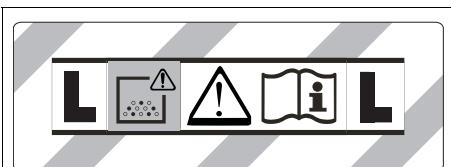
**VAROITUS:** Tämä laite sisältää terveydelle vaarallista pölyä. Tyhjennyksen ja huollon, pölypuzin poistaminen mukaan luetulla, saavat suorittaa vain asiantuntevat henkilöt, jotka kantavat soveltuvala henkilökohtaista suojarustusta. Älä kytke päälle, ennen kuin koko suodatinjärjestelmä on asennettu.
