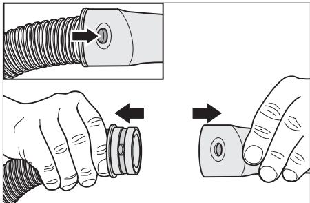
Il canale di aspirazione è dotato di un sistema a clip. Tutti gli accessori C-35/C-DN-35 possono essere collegati.
