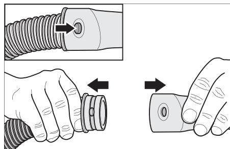
Sugeslangen er utstyrt med et clip-system. Alle C-35/C-DN-35-tilbehørsdeler kan tilkobles.
