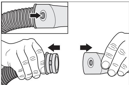
Wąż ssący zaopatrzony jest w system zatrzaskowy. Podłączyć można wszystkie elementy wyposażenia C-35/C-DN-35.
