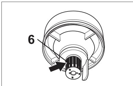
Впускной канал (6) оснащен поплавком.
