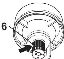
Imukanava (6) on varustettu uimurilla.
