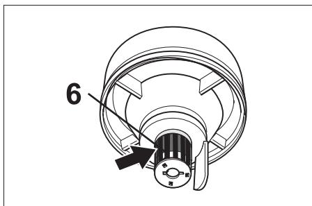
Le canal d'aspiration (6) est équipé d'un flotteur.
