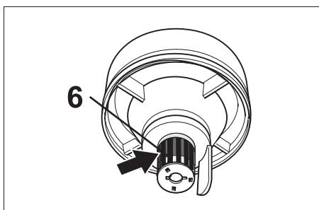
El canal de aspiración (6) está equipado con un flotador.
