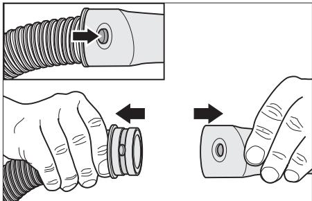
Всасывающий шланг оснащен системой клипсового соединения. Могут быть подсоединены все комплектующие изделия С-35/С-DN-35.
