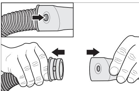
Imuletku on varustettu puristinliitoslukitulla. Kaikki C-35/C-DN-35:n saatavavissa olevat lisävarusteet voidaan liittää puristinliitokseen.
