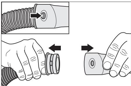
A szívótömlő bilincsrendszerrel van felszerelve. Valamennyi C-35/C DN-35 tartozék csatlakoztatható.
