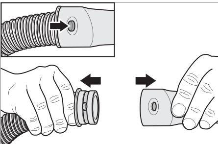
Sugslangen är utrustad med ett clip-system. Alla C-35/C-DN-35 tillbehörsdelar kan anslutas.
