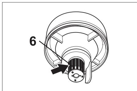
Usisni kanal (6) je opremljen plovkom.
