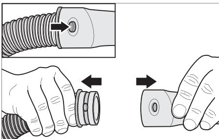
Der Saugschlauch ist mit einem Clip-System ausgestattet. Alle C-35/C-DN-35 Zubehörteile können angeschlossen werden.
