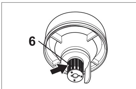
Смукателният канал (6) е оборудван с поплавък.
