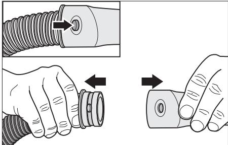
De zuigslang is van een clip-systeem voorzien. Alle C-35/C-DN-35 accessoires kunnen worden aangesloten.
