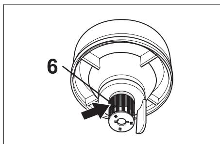
Der Saugkanal (6) ist mit einem Schwimmer ausgestattet.
