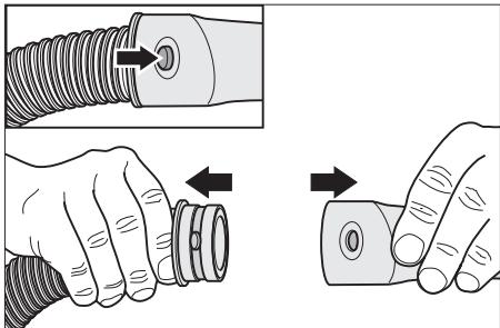
La manguera de aspiración está equipada con un sistema de clip. Se pueden conectar todos los accesorios C-35/C-DN-35.
