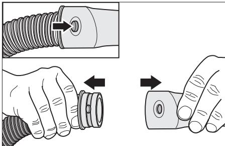
Le flexible d'aspiration est doté d'un système à clip. Il est possible de raccorder tous les accessoires C-35/C-DN-35.
