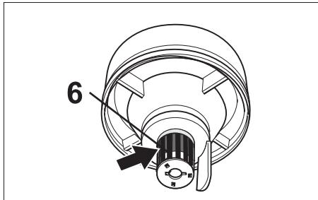
Il canale di aspirazione (6) è provvisto di un galleggiante.
