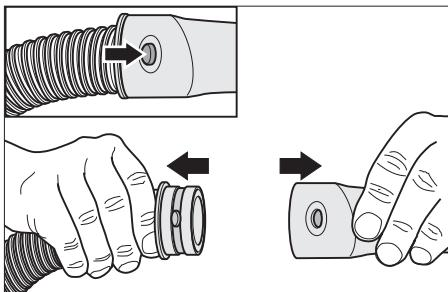
Всмукателният маркуч е оборудван със система с клип. Могат да се присъединят всички принадлежности C-35/C-DN-35.
