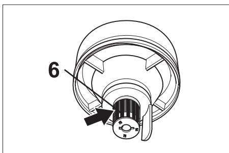
Kanał ssący (6) wyposażony jest w płynak.
